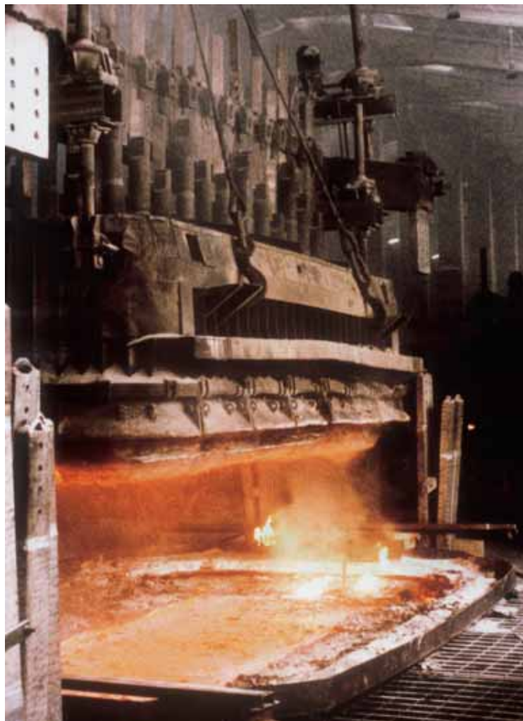
Menjava anod na pečeh v elektrolizni hali B
