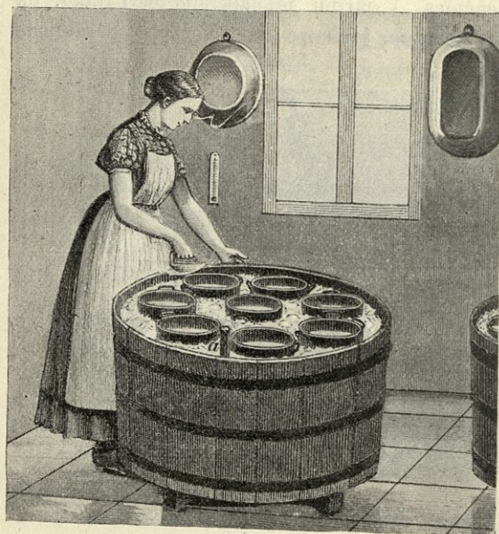
Slika 68. Švarcov sistem dobave smetane z ledom.
