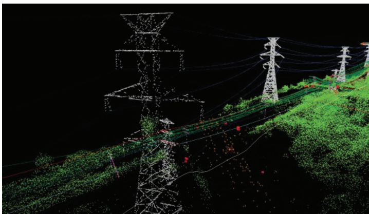
Slika 3: Prikaz oblaka točk na trasi daljnovoda.
