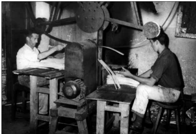
Strojno krivljenje dog v novi sodarski delavnici. Pri stroju levo Jakob Eržen iz Ojstrega Vrha, desno pa Matevž Trojar iz Železnikov. Foto: arhiv Betke Eržen, Ojstri Vrh
