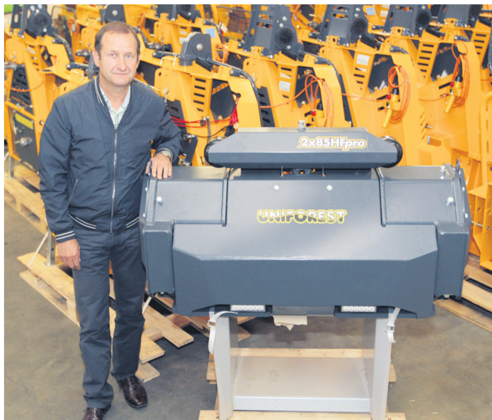
Direktor Drago Pintar pravi, da je ena od konkurenčnih prednosti podjetja vlaganje v razvoj. Trenutno je eden njegovih najnovejših izdelkov dvobobenski gozdarski vitel za fiksno pritrjevanje na gozdarski traktor.
