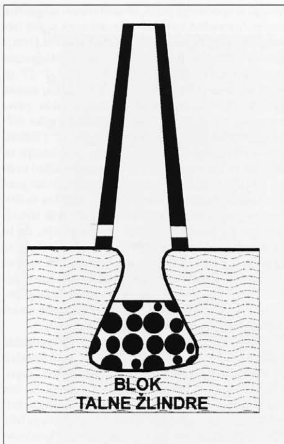
Sl. 5: Rekonstrukcija železarske talilne peči z blokom talne žindre v jami pod pečjo (prirejeno po Smekalova 1993, 84). Takšne peči so uporabljali pri ekstenzivnih metalurških procesih, kjer je bila vsaka peč uporabljena samo enkrat.
