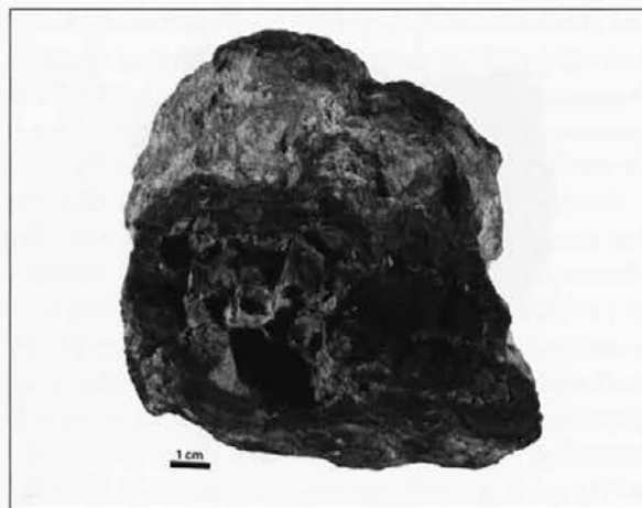
Sl. 20: Cvinger pri Meniški vasi. Gomoljasta limonitna koncentracija oz. bobova železova ruda - bobovec, kakršno so najverjetneje uporabljali tudi železnodobni železarji na Cvingerju pri Meniški vasi. Lepo je vidna skorjasta struktura, ki je posledica koncentričnega nalaganja železovih oksidov in hidroksidov (vzorec je odstopil Borut Križ).
