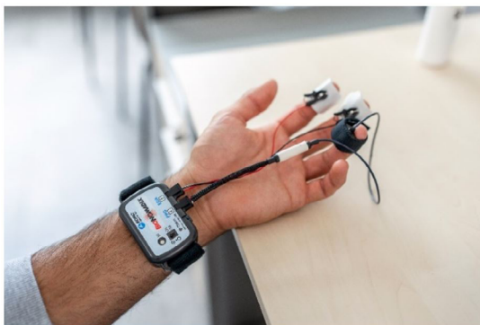
Slika 1: Laboratorijska oprema za merjenje fiziološkega odziva
