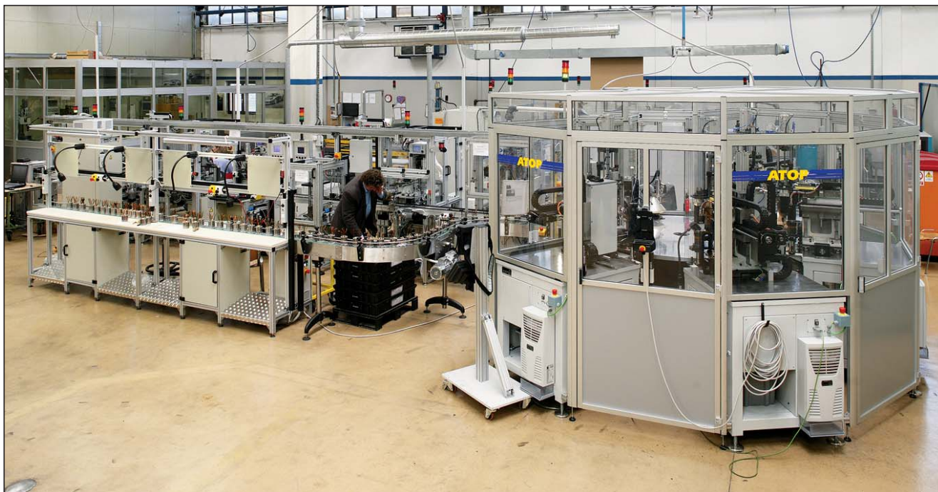
Montažni sistem za sestavljanje statorjev AC motorjev za servo volan Opel Astra
