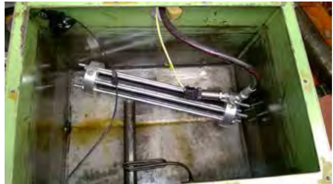
Slika 2 : Hidravlični valj s kompozitno cevjo v zaščitni komori pred visokotlačnim porušitvenim testom
