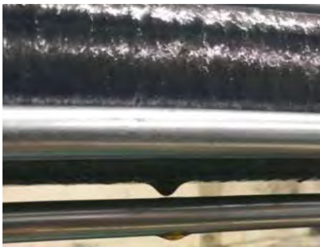
Slika 7 : Pojav zunanjega puščanja kompozitne cevi med oljno-hidravličnim trajnostnim testom HV
