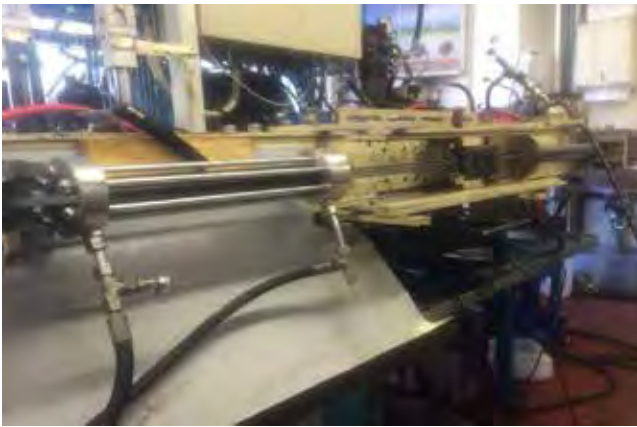
Slika 4 : Hidravlični valj s kompozitno cevjo na preizkuševališču pred začetkom trajnostnega testa
