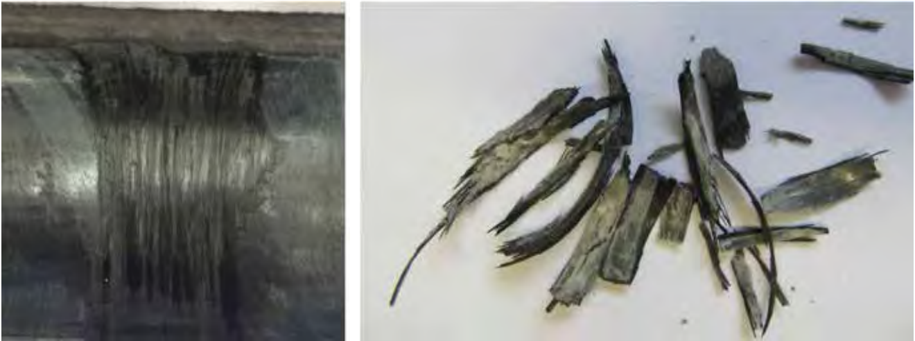
Slika 9 : Poškodovana drsna površina kompozitne cevi po predčasno prekinjenem trajnostnem testu
