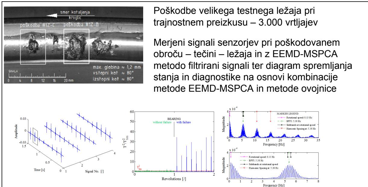
Multivariatna in večskalna statistična monitoring metoda, osnovana na kombinaciji metode EEMD in analize glavnih komponent za ležaje velikih dimenzij, je bila razvita in utemeljena z eksperimentalnim preverjanjem razvitih numeričnih materialnih modelov na namensko zgrajenem laboratorijskem preizkuševališču. Pomembna je za razvoj tehnik spremljanja obratovanja sistema, filtriranja signalov in za razvoj diagnostičnih metod.
