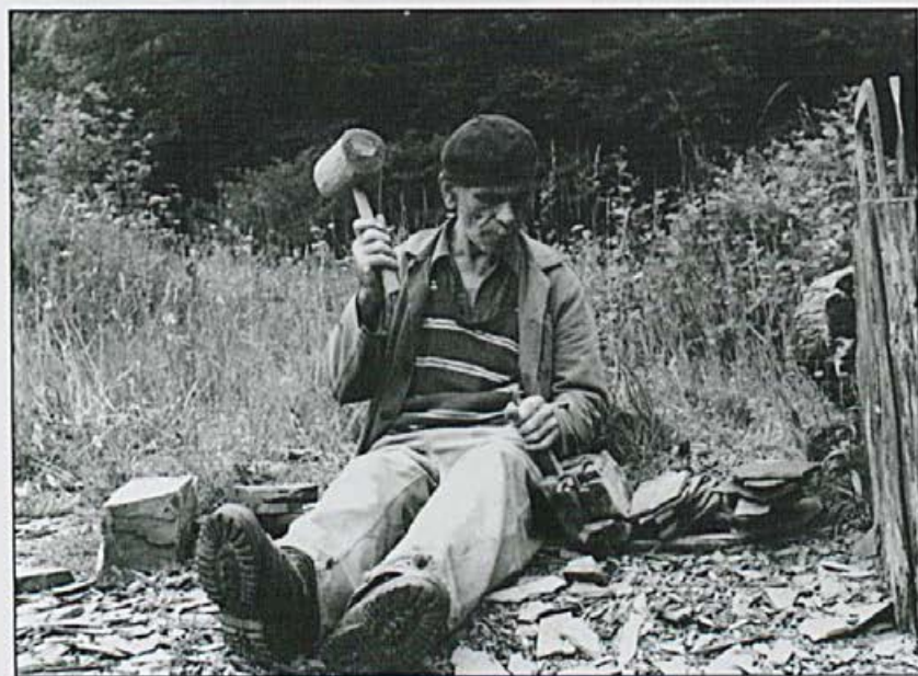
Način dela pri cepljenju skrilnih kvadrov. Foto: arhiv Muzeja Železniki
