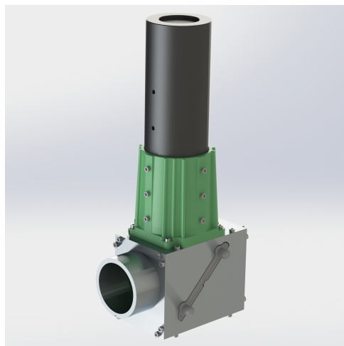
Slika 2: 3D model modula. Modul postavimo na vhod osvetlitve mikroskopa (sprednji del). Z zadnje strani priključimo obstoječo halogensko osvetlitev, z zgornje strani pa ima modul integrirano stroboskopsko osvetlitev. Z izvlečnim zrcalom izbiramo tip osvetlitve, s katerim želimo osvetljevati vzorec.
