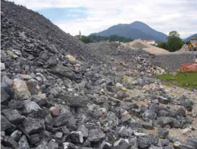
Odvai materiala, izkopanega v predoru Pod Stenom v juniju leta 2012. Na tem delu je v glavnem črni apnec, prepređeno s kalcitovimi žilami. Foto: Vili Rakovec.
