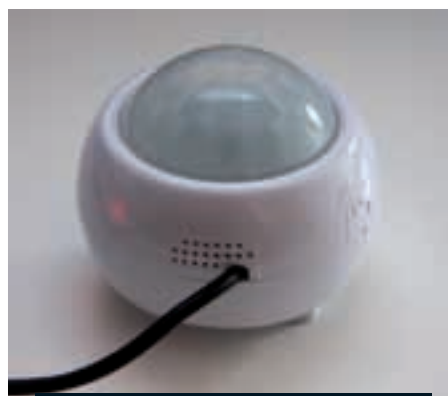
Štirikratno tipalo je NSA v malem – meri temperaturo, vlago in osvetlitev ter opreza za nepovabljenimi gosti
