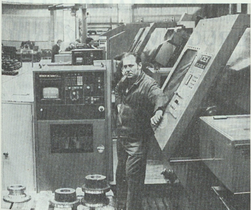
Krmilne omare — procesni računalniki številsko krmiljenih obdelovalnih strojev v tozdu TVN (Foto J. Jereb)
