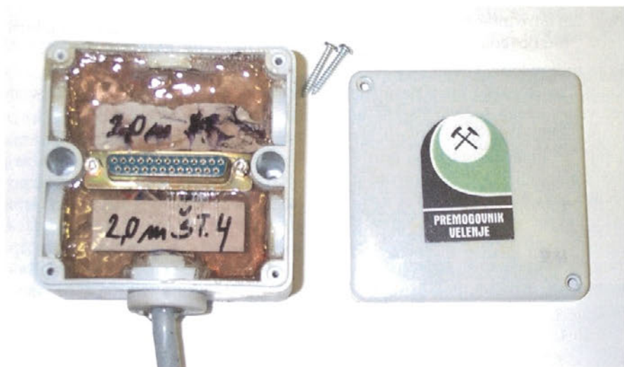
Konektor, zaščiten z elektrorazvodnico in zalit s smolo.
