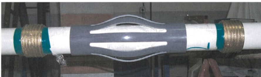
Rozeta, nameščena na mersko cev ekstenziometra, ki preprečuje premikanje merskih obročkov.
