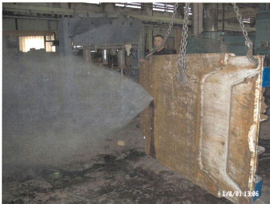
Stropnik podporja z vgrajeno visokotlačno vodno šobo-zgoraj, računalniški nadzor porabe energentov-spodaj
