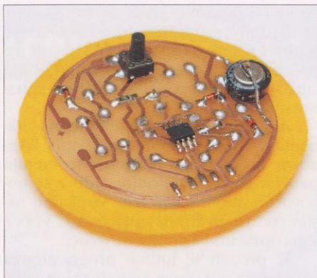
Namestitev elementov na »bakreno« stran tiskanine
