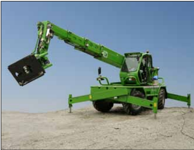
Slika 1. Hidravlično teleskopsko dvigalo Merlo ROTO MCSS 45.21 za manipulacijo bremena z maso 2000 kg
