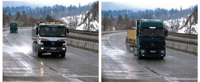
Slika 6. Kalibracijski vozili: levo, 3-osno vozilo; desno, 5-osno vozilo 113 [Žnidarič, 2018].
