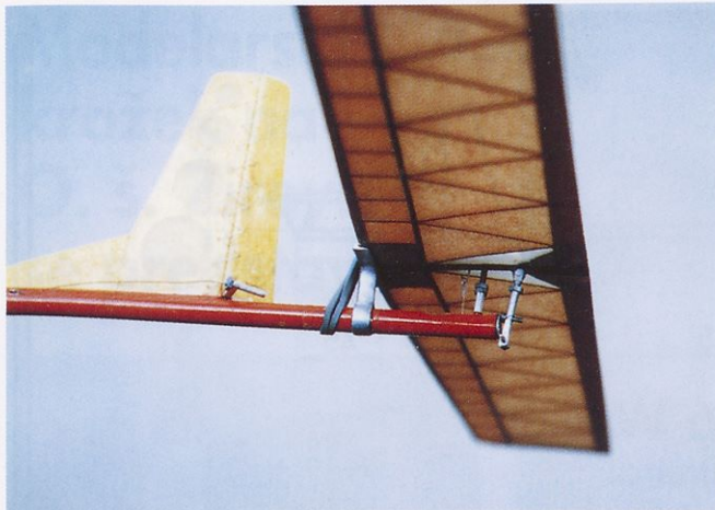
Pogled na mehanizem, ki med letom omogoča različne kote višinskega repa.
