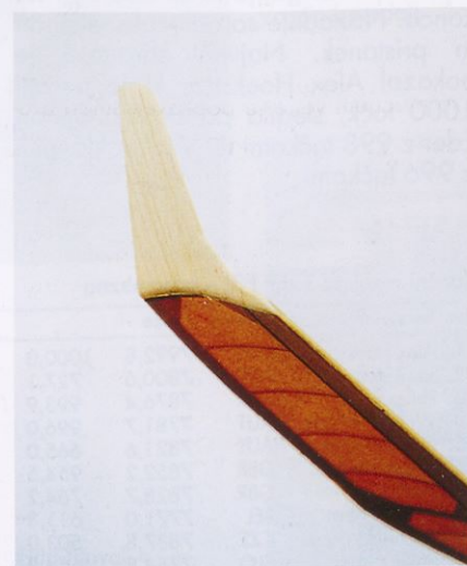
Zavihki na krilu pripomorejo k večji stabilnosti modela.
