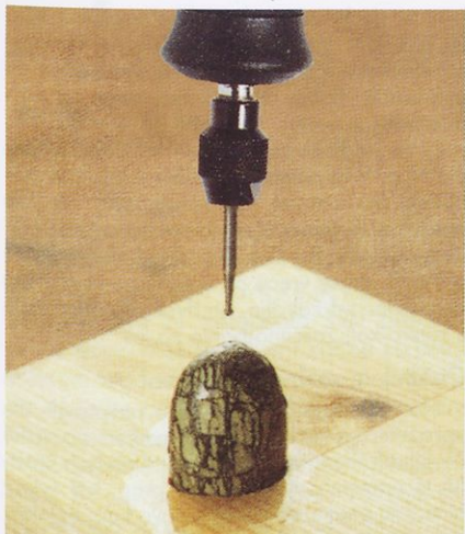
Slika 3. Vrtanje luknjice, v katero vlepate ušesce iz žice
