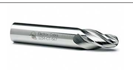
Slika 7. Primeri laserskega označevanja: odstranjevanje barve s transparentnih gumbov, zapis oznake na karbidnem orodju in zapis tehničnih podatkov na plastičnem ohišju
