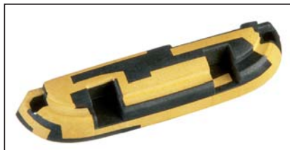
Slika 6. Antena mobilnega telefona, izdelana v tehnologiji 3D-MID
