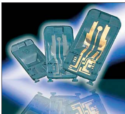
Slika 5. Ponazoritev treh faz izdelave 3D-vezja: brizgani odlitek pred lasersko aktivacijo, po njej in po bakrenju/zlatenju
