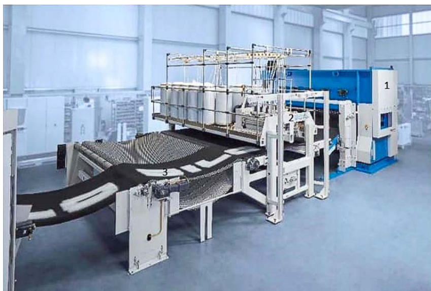
Slika 4: Dilova linija z vključenim sistemom »3-D loft« 1 - dovajanje koprne; 2 - sistem »3-D loft« 3 - izdelana 3-D tekstilija [5]
