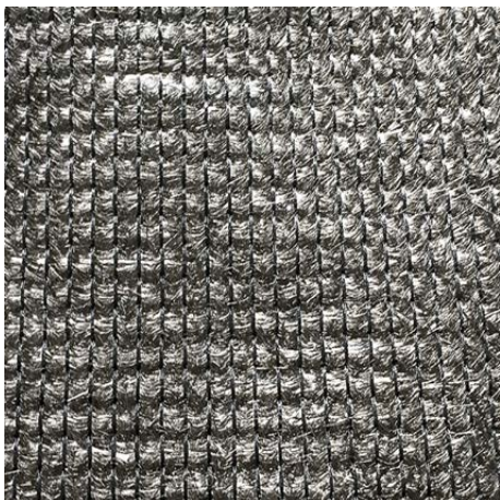
Slika 14: Netkana tekstilija Maliwatt iz recikliranih ogljikovih vlaken [12]
