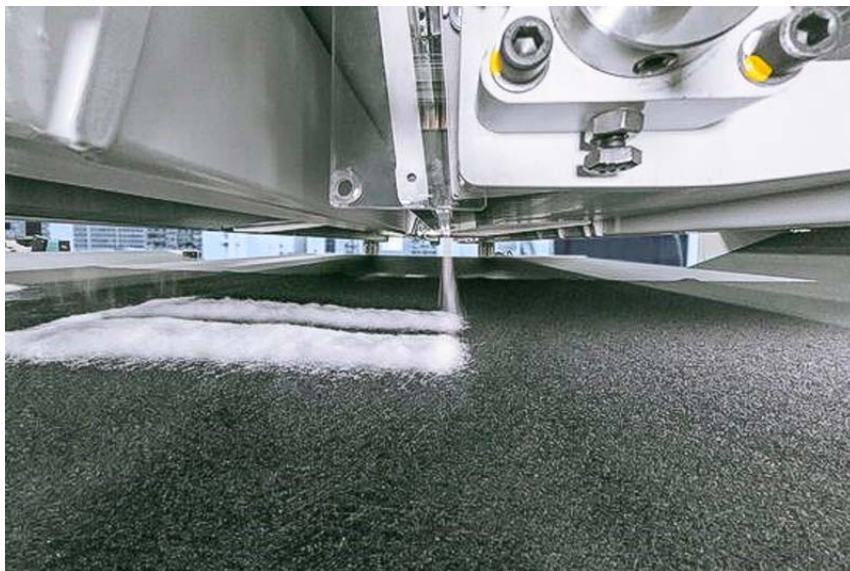
Slika 3: Dilov sistem »3-D loft« – napihana množica tridimenzionalno usmerjenih vlaken [5]
