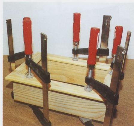
Slika 8. Stik ohišja in letvic čelnega okvirja med sušenjem lepila utrdite z nekaj mizar-skimi svorami.
