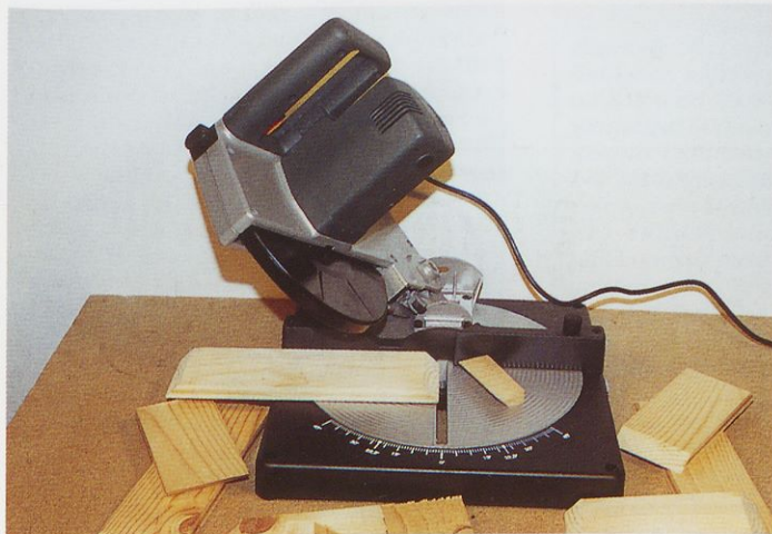
Slika 2. Žaganje sestavnih delov ohišja stenske vitrine iz smrekovih deščic s prerezom 15 x 80 mm
