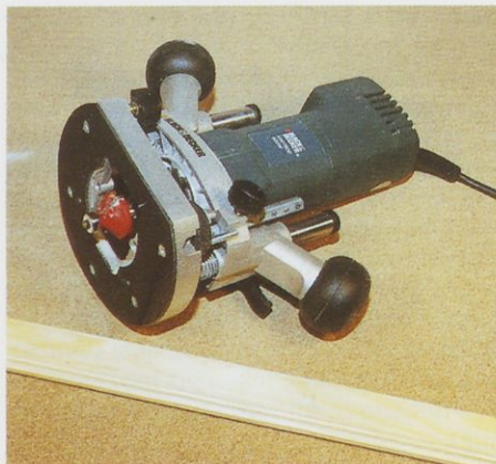
Slika 6. Profil letve za izdelavo čelnega okvirja je odvisen od oblike rezkarja, vpetega v rezkalnik.
