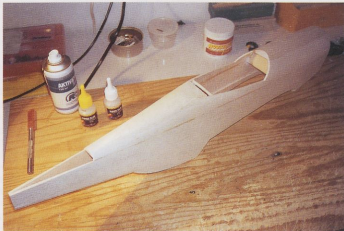
Slika 4. Trup različice D je izgotovljen, dodati je treba še kabino in prilepiti rep.
