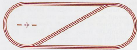
Märklinov sredinski odvzem v sistemu H0 omogoča na maketi postavitve tirov v pentljah.
