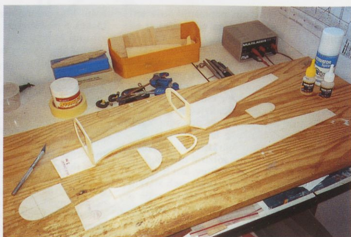
Slika 2. Sestavni deli trupa pred lepljenjem. Levo in desno polovico zlepimo prek reber 2 in 4; pri tem pazimo, da je trup popolnoma poravnana.
