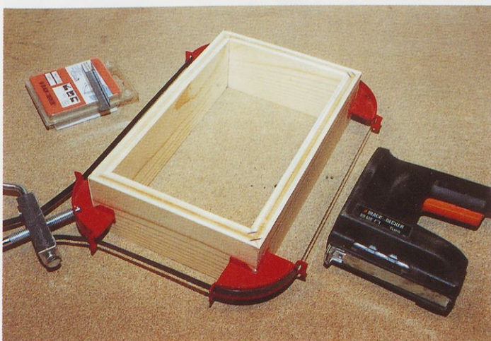
Slika 4. Uporaba kovinskih sponk na poševnih stikih letvic sicer ni obvezna, vsekakor pa je priporočljiva.
