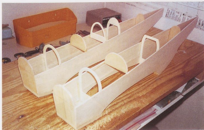
Slika 3. Trupa za različici B in D sta v grobem zlepljena. Opazna je razlika pri rebrih 3A in 4. Manjkata samo še zgornja zaključka trupov in repa.
