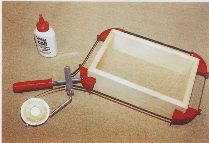
Slika 3. Če letve med sušenjem lepila vpinete v takšen pripomoček, ni bojazni, da okvir ne bi bil res pravokoten.
