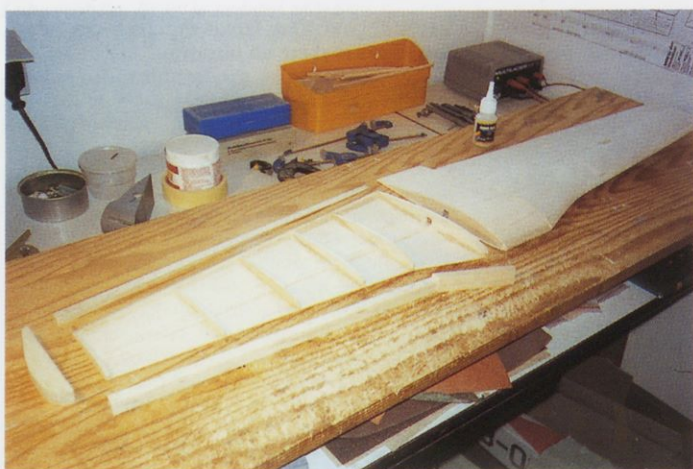
Slika 1. Leva polovica krila z osrednjim delom je že sestavljena, desna še čaka na to. Za nedokončano polovico je viden klin za doseg pravilnega geometričnega zvitja krila pri lepljenju zgornje oplata.
