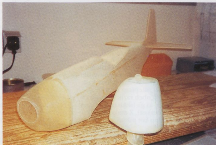
Slika 6. Manjka še pokrov motorja, ki ga izdelamo iz ELSV. Postopek je bil opisan v četrti številki Tima.
