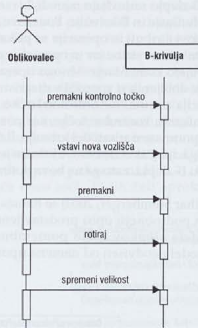
Slika 5: diagram zaporedja za B-krivulje.
