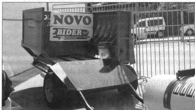
Rezalnik balirane živinske krme Jožeta Bidra omogoča zajemanje in nakladanje posamezne bale krme brez pomoči druge osebe
