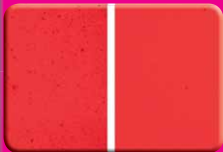
Nova pigmentna osnova daje bolj zanesljiv homogen odtis (levo običajna UV-tiskarska barva, desno nova UV-tiskarska barva New V Maxx).
