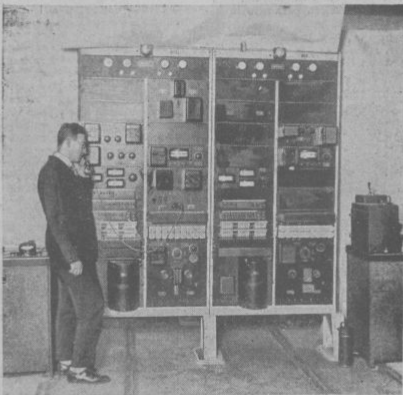
Aparati slikovnega brzojava sistema Siemens-Karolus-Telefunken. Na levi oddajnik, na desni prejemnik. Jasno se vidi kompliciranost celotne ureditve
