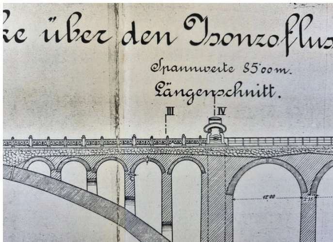
Slika 15. Detajl načrta za Solkanski most iz leta 1904, na katerem sta narisana različna tipa Wagnerjeve ograje [SŽ, 2022].
