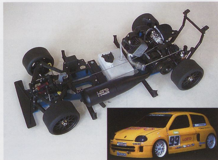
Podvozje Larojevih RV-avtomobilov (1 : 5) z motorjem 23 cm 3 , ki poslej sodijo v Mantuino skupino. Nanj po želji postavimo karoserije vozil clio, laguna, peugeot 406, BMW serije 3 ali dodge ram.
