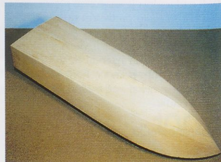
Slika 8. Pri brušenju si pomagajte s ploščato pilo in brusilnim papirjem, ki ga ovijete okoli večje deščice.
