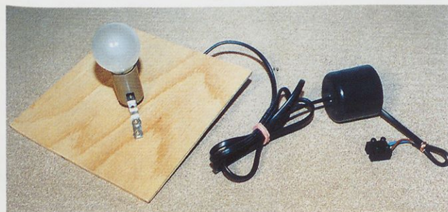
Slika 9. Električni del svetilke; skoraj vse potrebne dele lahko vzamete od odslužene stropne svetilke.
