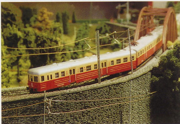
Slika 8. Dobro so vidne s fotokemičnim postopkom obdelane stranice.
