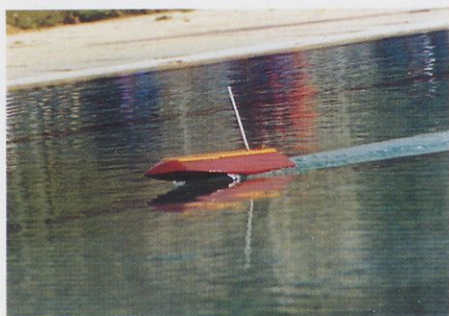
Hitrostni model razreda MČ-2 z mehanizmom za izklop motorja, ki ga aktivira vrvica, napeta nad ciljno črto.
