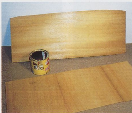
Slika 4. Čez prvo plast pravokotno položite kose druge plasti furnirja in zlepek dobro stisnite ali povaljajte.
