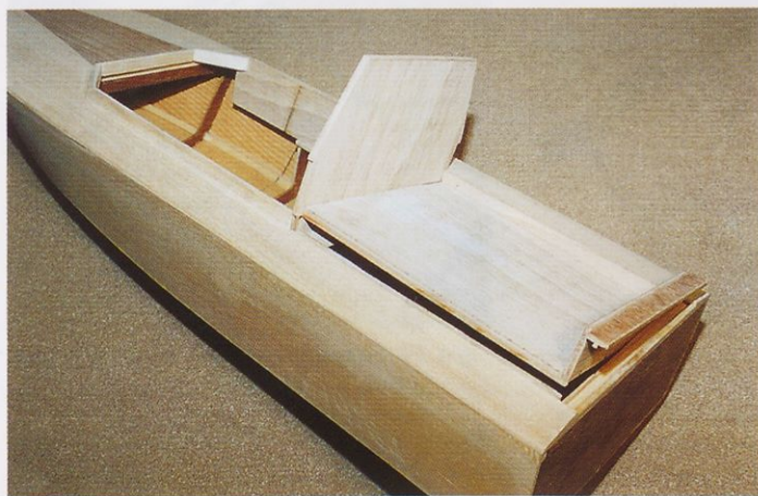
Slika 12. Ves zadnji del je mogoče izvleči ter tako priti do vgrajene opreme.
