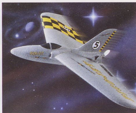
Multiplexov stiroporni pico jet bo nedvomno vroča tema sezone. Sestavite ga v pičlih dveh urah in že lahko uživate v vragolijah v zraku. Obstaja tudi izvedenka, namenjena za zračni boj. Razpetina kril 895 mm, motor Permax 400 ali 480 v verziji "combat".
