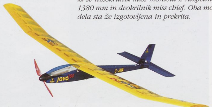
Java 150 z razpetino 1500 mm je mali jadralni RV-model z neposrednim električnim pogonom. Uporablja motor vrste "400" s 6-8 celicami Ni-Cd. Izgotovljen in že prekrit model je idealen za začetnike (Scorpio).
