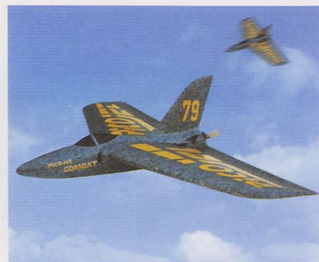
Multiplexov stiroporni pico jet bo nedvomno vroča tema sezone. Sestavite ga v pičlih dveh urah in že lahko uživate v vragolijah v zraku. Obstaja tudi izvedenka, namenjena za zračni boj. Razpetina kril 895 mm, motor Permax 400 ali 480 v verziji "combat".
