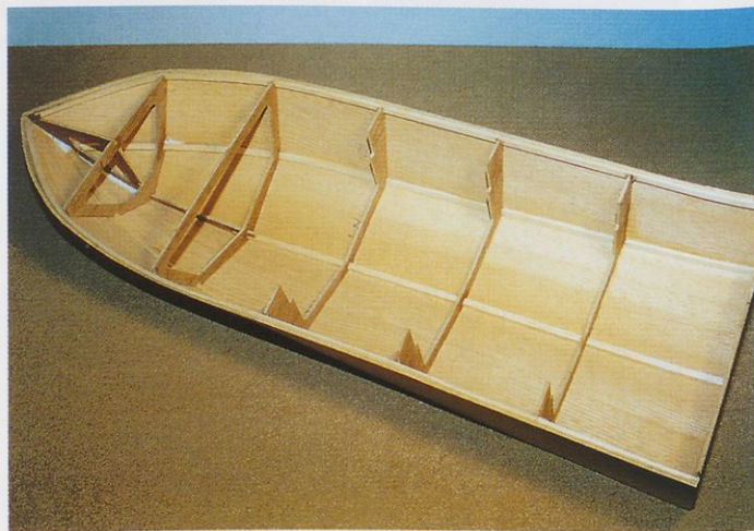
Slika 7. Notranjost korita dvakrat prelakirajte, da bo bolj odporna proti vlagi.
