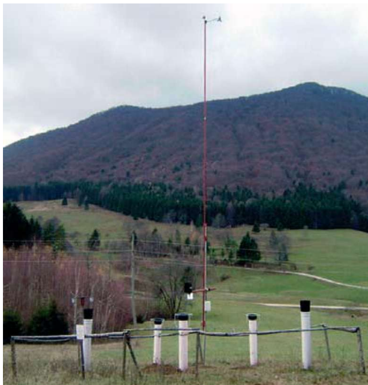
Slika 2: Samodejna meteorološka postaja z vzorčevalniki za dež in sneg v kraju Borovec (Foto: Iztok Sinjur)
