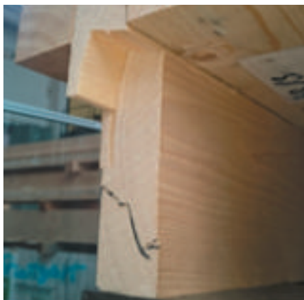
Slika 7 • Fotografije razpok (Zisi, 2016): v robnem rebri (levo), v srednjem rebri (sredina), v robnem rebri ob porušitvi plošče (desno)
