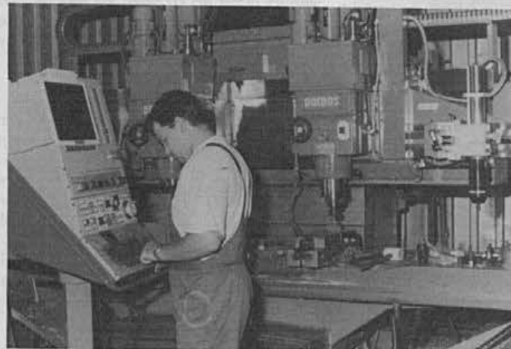
Obstoječa CNC kopirka bo povezana s CAD-CAM sistemom, v verigi z novim instaliranim Ferrari CNC rezkalnim strojem
