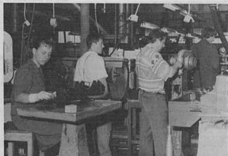
Mazanje, poliranje in nanašanje lepila na ringu
