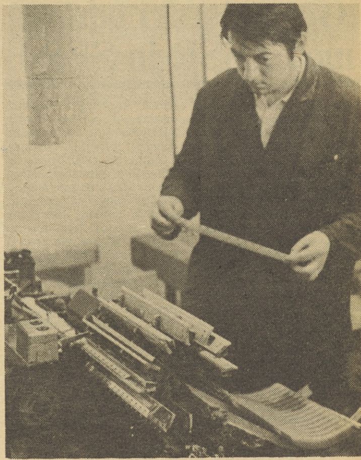
Na novem stroju je spajkanje kontaktov znatno hitreje, saj jih en delavec na dveh strojih lahko naredi 40 do 44.000 v eni izmeni
