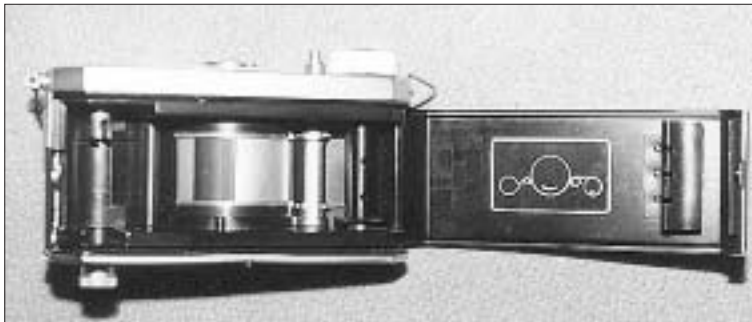
Slika 3: Notranjost kamere Horizont z režo
