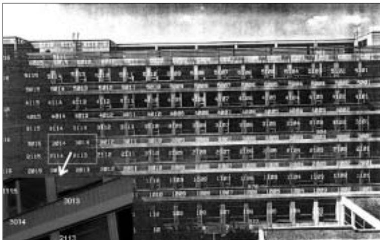
Slika 5: Testno polje. Kalibracijske točke so razvrščene po vrsticah in stolpcih.
