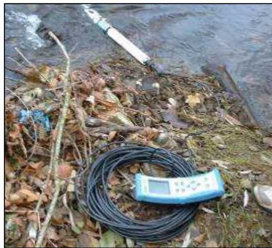
Slika 3 – Merilec višine vode Starflow (levo) in multiparametrška sonda Hydrolab (desno)
