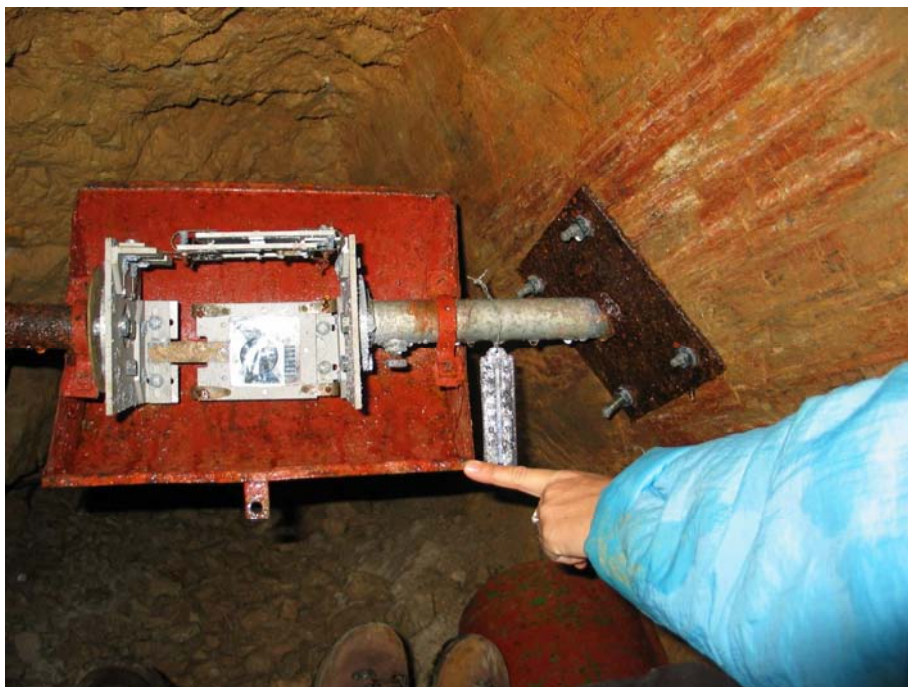
Slika 3 – Tektonske drse in TM 71 v Lepih jamah, Postojna 2 (foto S. Šebela)
