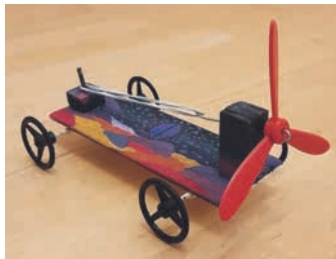
Avtomobilček je naredila Sara Jankovec iz 6. a pri neobveznem izbirnem predmetu Tehnika. Izdelali so avtomobilček po navodilih iz tehnične škatle. Avtomobilček se navje in se nato pelje sam od sebe.
