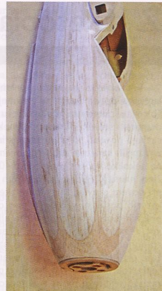
Slika 9. Oblečen in obdelan sprednji del trupa. Z brušenjem se prikaže zanimiva storžasta struktura, ki pomaga pri ocenjevanju simetrije.
