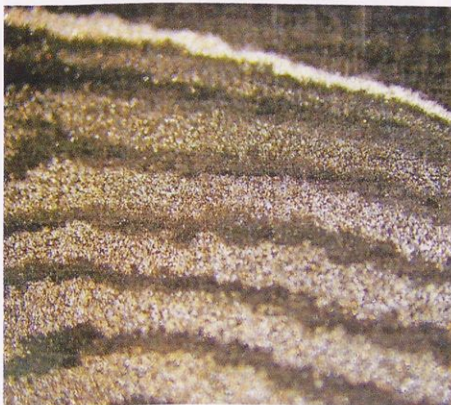
Na povečani sliki se lepo vidijo vzorci v sodobnem damaščanskem rezilu
