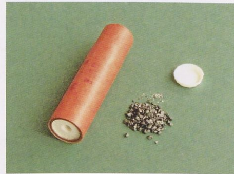
Slika 2. Iz motorja je treba iztresti odbojno polnjenje.
