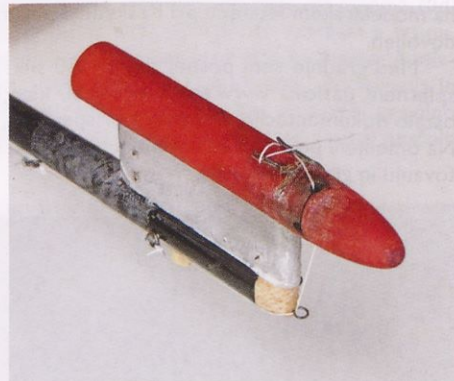
Slika 3. Pogled na kontejner raketoplana z zložljivim krilom z izvrtinami za odvajanje plinov
