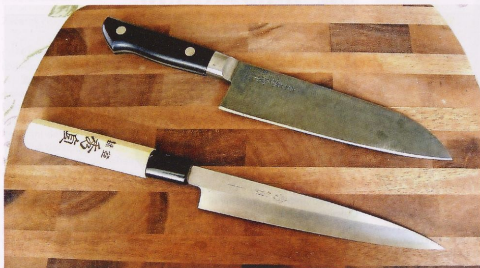
Japonska kuhinjska noža iz ogljikovega jekla trdote okrog 60 Hrc
