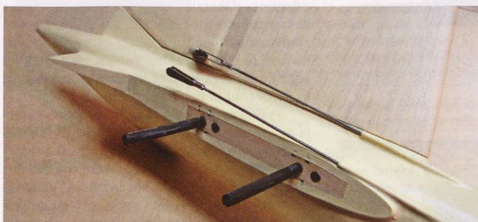
Slika 11. Rep je nasajen na trup na 6-mm karbonske bajonete, ob katerih močni magneti držijo rep pri trupu.
