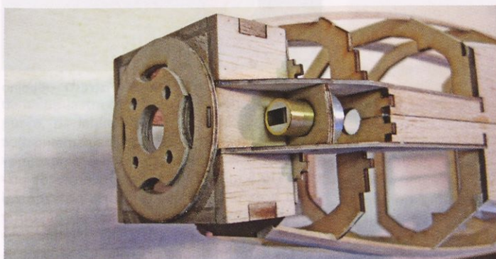
Slika 7. Grobo sestavljen nosni del trupa. Prva dva centimetra sta še pravokotna.
