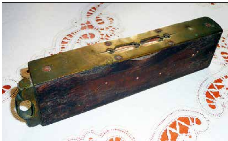
Vodna tehtnica kot mlinarjeva pomoč pri namestitvi zgornjega kamna v Egrovem mlinu v Železnikih. Foto: Katja Mohorič Bonča
