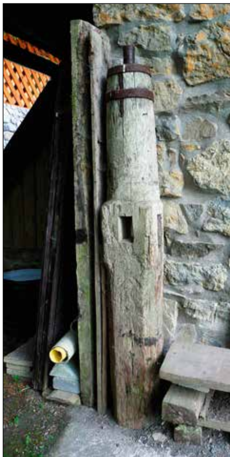
Ostanki mlinске naprave Jureževega mлина v Davči. Lepo se vidi, kako je bil štekl nasajen v gred. Foto: Katja Mohorič Bonča
