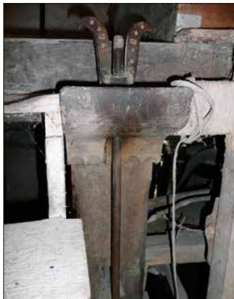
Vijak, s katerim je mlinar reguliral razdajo med mlinskima kamnoma. Fortunov mlin v Hotovlji. Foto: Katja Mohorič Bonča
