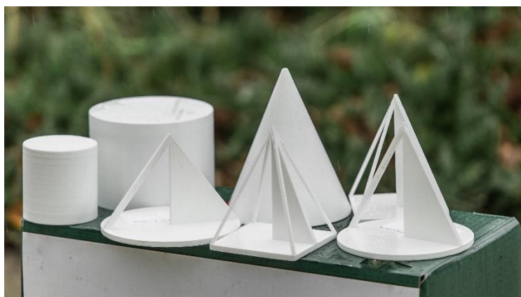
Slika 1: Modeli na sliki, ki smo jih uporabili pri predmetu matematike, in so natisnjeni s pomočjo metode FDM. Uporabljen filament je PLA v beli barvi.
