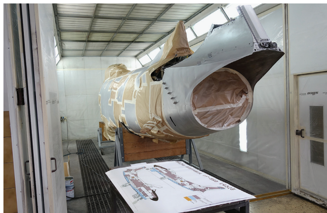
Zaščiteno trup letala (16. 6. 2015) čaka v komori za barvanje na nanos drugega odtenka barve aluminija, s katerim smo razbili monoton videz prvotnega nanosa. Pred letalom je na pultu videti eno od delavniških skic z natančno razporeditvijo posameznih barvnih odtenkov. (Foto: arhiv Tomaža Permeta)
