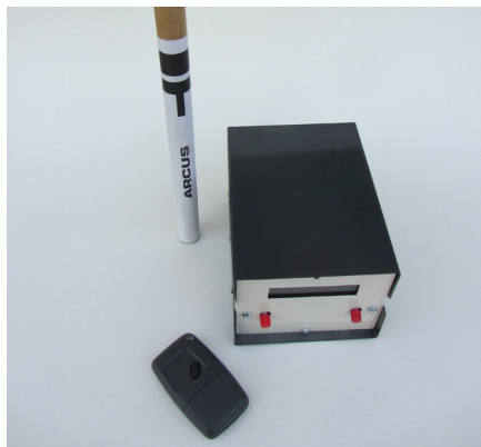
Bazno postajo šarterja za raketne modele upravljamo z radijskim daljinčkom, torej tudi vžig motorja raketnega modela.
