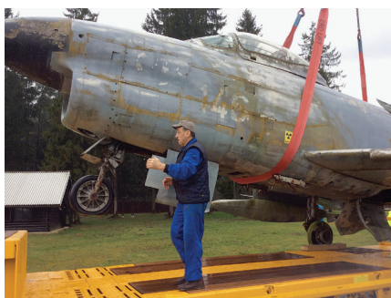
Alojz Potočnik pridržuje letalo IF-86D sabre med nalaganjem na vlačilec. Na desnem boku pred korenem krila se vidi označba, da je letalo zaradi nekaterih instrumentov radioaktivno. (Foto: arhiv Alojza Potočnika)
