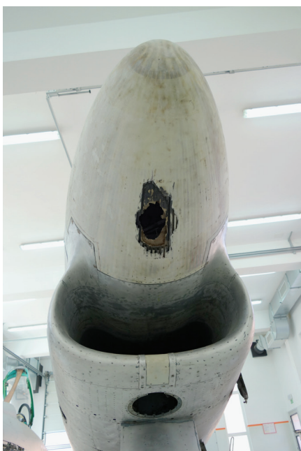
Poškodbe na radarskem pokrovu kažejo sasto strukturo pokrova. Spodaj pred srednjim kolesom je prazna odprtina, v kateri bi moral biti vgrajen uvlačljivi pristajalni reflektor. (Foto: arhiv Tomaža Permeta)
