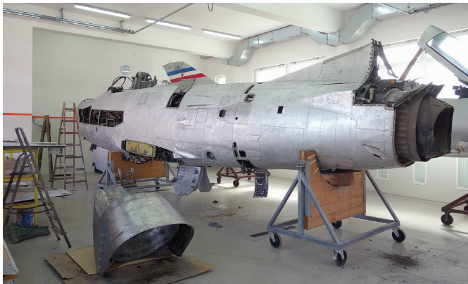
Trup letala IF-86D, s katerega je bila očiščena barva, fotografiran v delavnici 29. 4. 2015. Zadaj se lepo vidi loputasta šoba letalskega motorja J47-GE-17B. (Foto: arhiv Tomaža Permeta)
