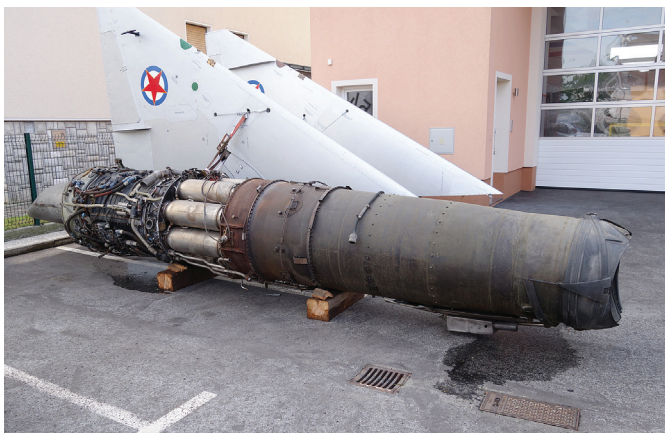
Motor letala IF-86D J47-GE-17B je zasedal več kot polovico dolžine trupa. Motor predstavlja vrhunec tehnologije petdesetih let prejšnjega stoletja. Žal danes ni postavljen na ogled v muzeju poleg letala, iz katerega je bil vzet prav za ta namen. (Foto: arhiv Tomaža Permeta)
