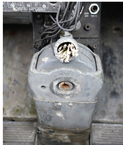
Odžagana ročica za upravljanje. Če bi ročico le odvil, bi jo zlahka nadomestili z novo. (Foto: arhiv Tomaža Permeta)
