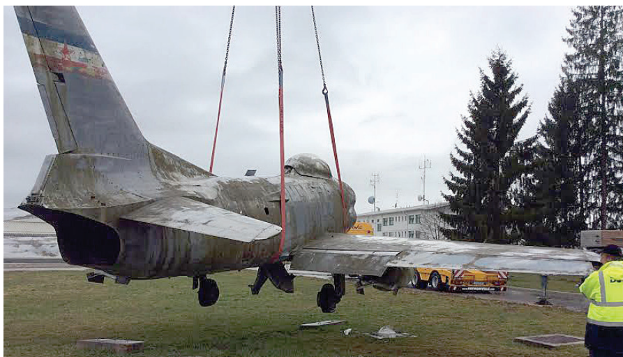
Letalo IF-86D sabre med dviganjem z betonskih podstavkov. Na severni strani je bilo prekrito s tanko plastjo zelenega mahu, ki se je več let nabiral na površinah, ko je letalo stalo na tej lokaciji. Prejšnja dviganja letala in premeščanja po letalski bazi so povzročila poškodbe na mestih, kjer so bile nameščene vrvi. Dviganje letala na desni usmerja polkovnik Mihael Klavžar (26. 3. 2015). (Foto: arhiv Alojza Potočnika)
