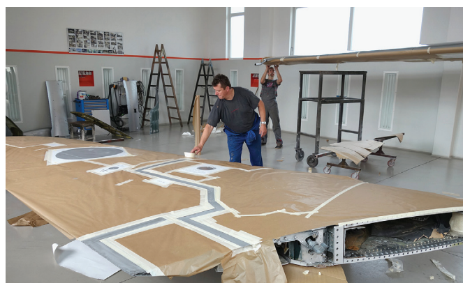
Maskiranje in zaščita krila pred barvanjem šablon in oznak na levem krilu IF-86D (13. 7. 2016) (Foto: arhiv Tomaža Permeta)
