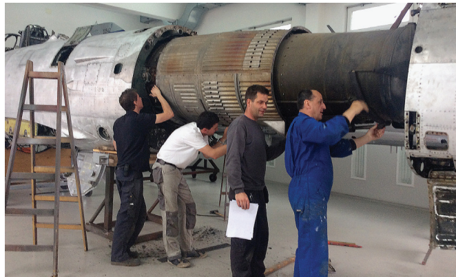
Alojz Potočnik (skrajno desno) in Jure Ferber (drugi desno) z ekipo pomočnikov 5. 5. 2016 med zahtevnim odstranjevanjem motorja iz trupa letala IF-86D. Sistem odstranjevanja zadnjega dela trupa in pritrditve motorja je pozneje prevzela tudi tovarna Soko pri letalih galeb G-2/G-3, jastreb J-21/NJ-21/INJ-21 in orel J/IJ/NJ/INJ-22. (Foto: arhiv Tomaža Permeta)
