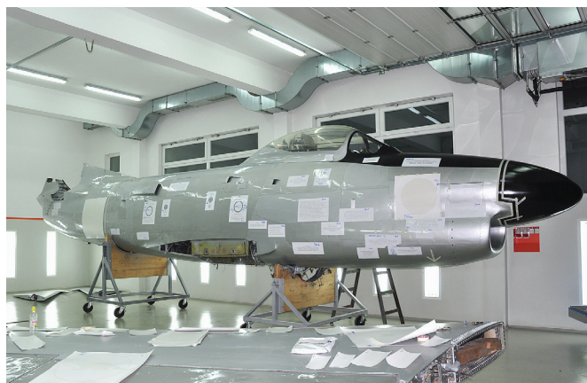
Letalo IF-86D je opremljeno s šablonami in maskami za barvanje. Na šablonah so različni opozorilni napisi in oznake na letalu z navodili za pomoč pri vzdrževanju letala (1. 7. 2015). (Foto: arhiv Andreja Kogovška)
