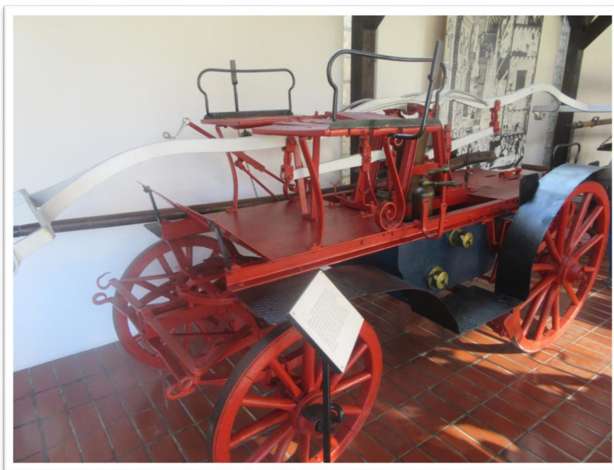
Ročna brizgalna metliške brambe, izdelana leta 1912. Če jo primerjamo s starejšimi modeli, opazimo, da je bila vitkejša, manjša in s tem zagotovo lažja za uporabo. Obenem lahko nosi vse cevi in potrebna orodja. Razvoj brizgaln je zmeraj šel v smer lažje uporabe in večje učinkovitosti.
