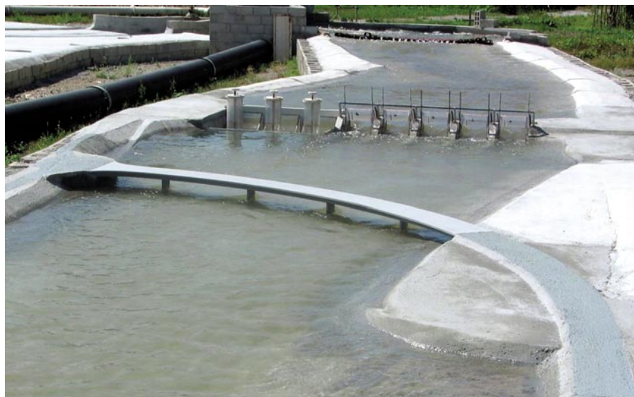
Slika 5 • Primer fizičnega modela (Inštitut za hidravlične raziskave; odsek Save s HE Krško in novim mostom)
