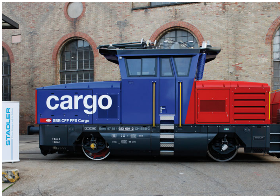
Stadlerjeva hibridna lokomotiva serije Eem 923 (foto: SBB, Zvonimir Pisonic)
