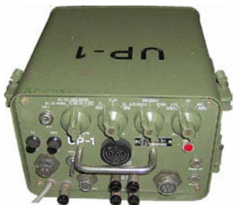
Slika 9 Telegrafski modem UP-1
