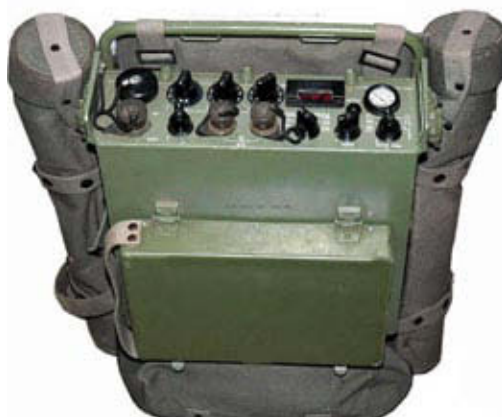
Slika 13 Komplet VHF radijska postaja RT-20 TM t. i. RUP 20 (foto: Dragan Pavičević)
