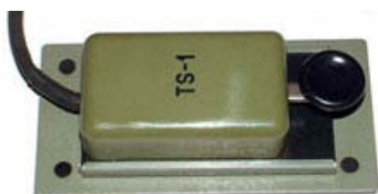
Slika 10a Taster za Morsejevo abecedo TS-1
