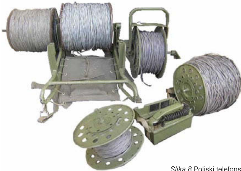
Slika 8 Poljski telefonski kabli PTK-56
