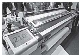
Slika 15: Tkalski stroj Zak 9200i podjetja Tsudakoma (širina 190 cm) [18]
