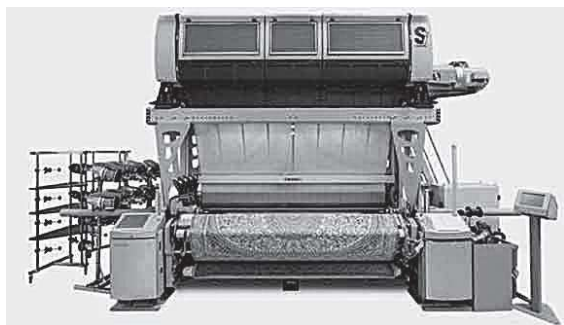
Slika 19: Bonasov žakar Si z 18.500 platinami, nameščen direktno na tkalski stroj DORNIER P1, PTS 8/J G [19]
