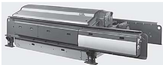
Slika 16: Stroj DORNIER air-jet weaving A1 AWS 4/J G v kombinaciji z žakarskim mehanizmom Staübli LXL [7]
