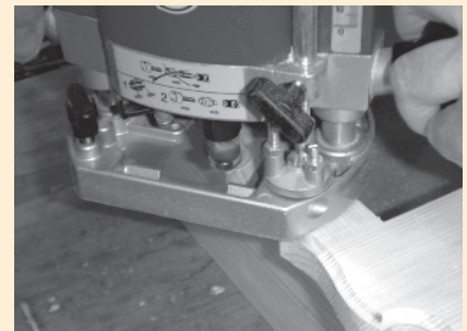
□ Slika 1. Obdelava robov izdelka z uporabo rezkarja z ležajem
