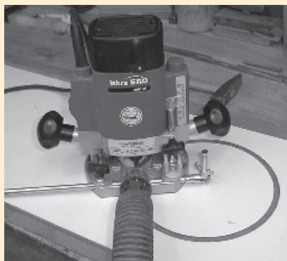
□ Slika 4. Izrezovanje izreza polmera 100 mm
