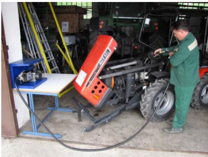
Slika 1: Točenje dizelskega goriva z električno črpalko, ki je opremljena z merilnikom iztočene količine goriva, po opravljeni delovni operaciji na kmetiji
