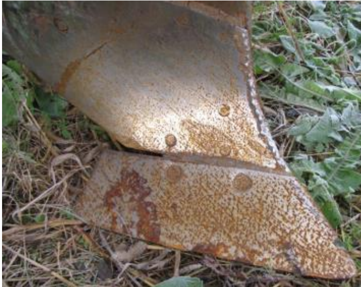
Slika 8: Praviloma je potrebno izrabljene dele nadomestiti z novimi. Take navarjene obloge sicer plužno desko zavarujejo pred nadaljnjo (večjo) obrabo, so pa potrebne vlečne sile bistveno večje. Večja pa je tudi poraba goriva. Po koncu sezone oranje je priporočljivo plug tudi konzervirati, da ni izpostavljen koroziji (rji).
