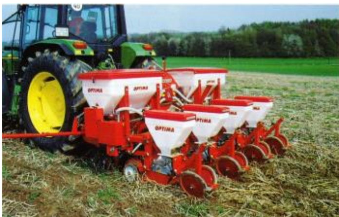
Slika 16: Direktna setev semena koruze v žetvene ostanke prejšnje kulture
