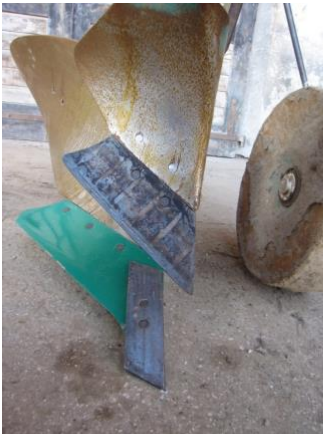
Slika 9: Pravilno obnovljen plug z originalnimi nadomestni deli (lemež, konica lemeža, lemež na predplužniku). Pred oranjem je dobro, če uporabnik odstrani še barvo iz novih delov. Sicer se ta tudi med oranjem sama „zbrusi“, je pa v času takega odstranjevanja barve poraba goriva spet večja.
