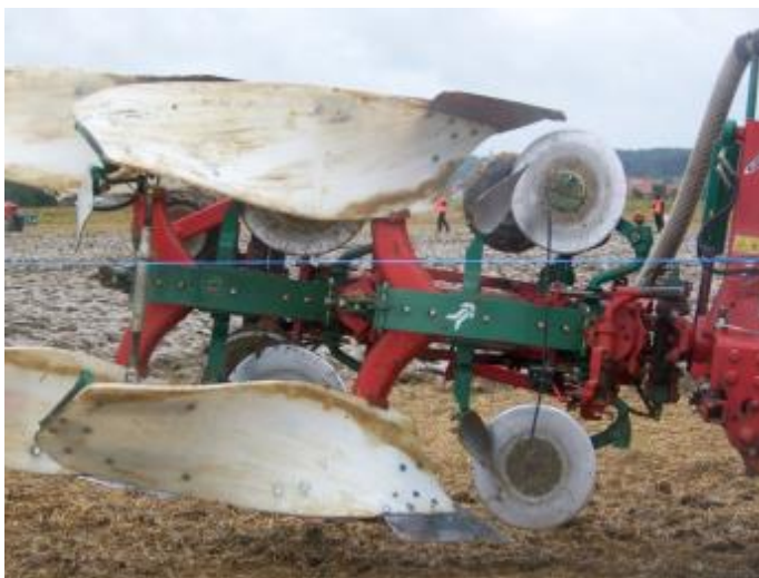
Slika 10: Plugi s plastičnimi deskami, potrebujejo za delovanje manj energije – goriva, plastične deske so primerne zlasti za lepljiva tla.
