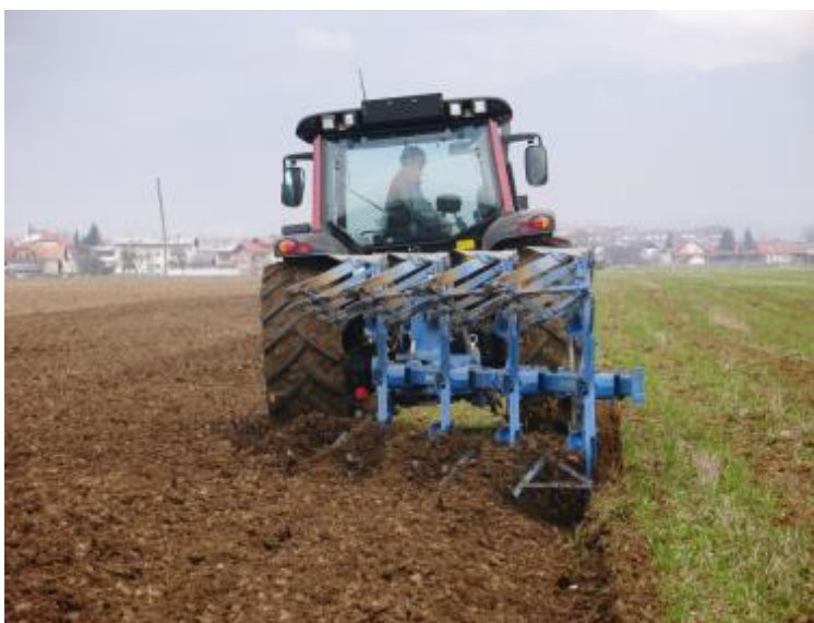
Slika 11: S trakastimi (rešetkastimi) plužnimi deskami tudi lahko zmanjšamo porabo goriva. Zaradi vibracij posameznih trakov naj bi bilo tudi drobljenje brazde bolj intenzivno. Poleg tega je tudi manj stroškov pri menjavi posameznih izrabljenih delov.
