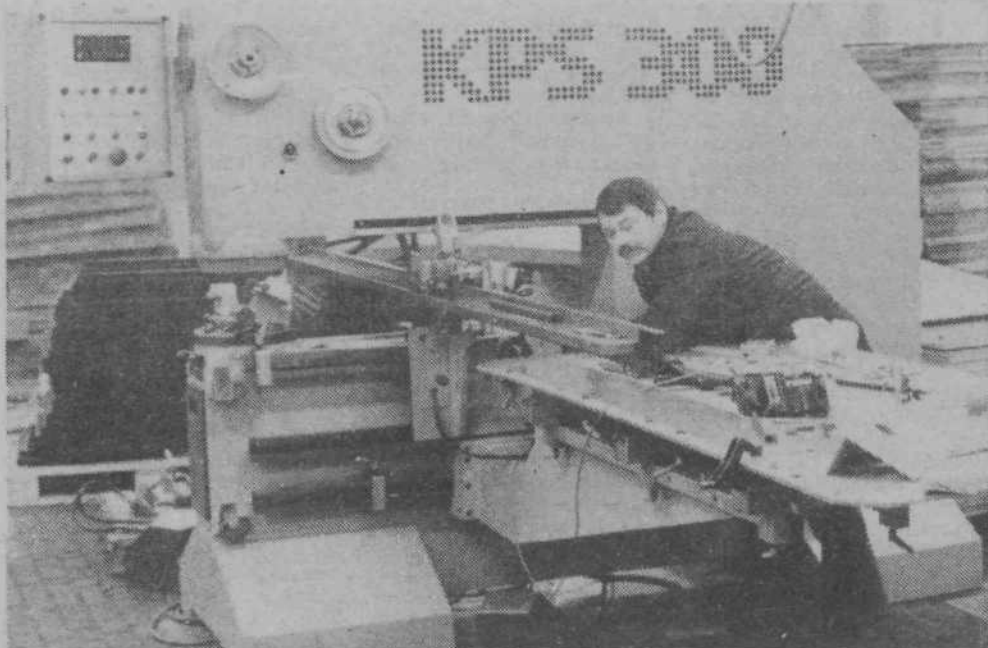
KPS 300 je nov proizvod savelske tovarne. To je sodoben koordinatni prebijalnik pločevine. Foto: A. D.
