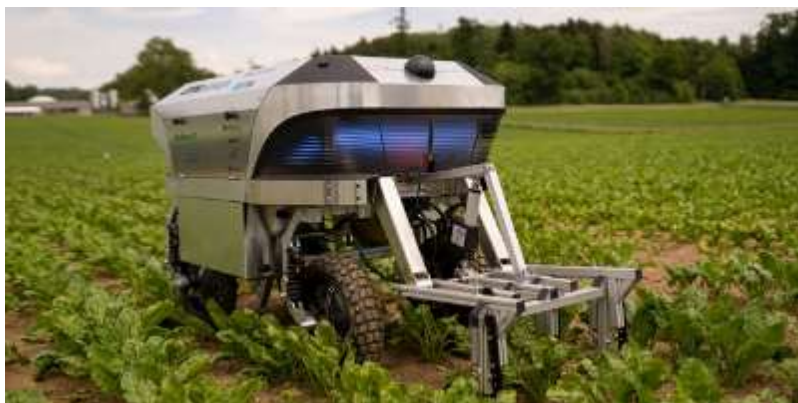
Slika 4: Avtonomni robot za mehansko odstranjevanje plevela med vrstami zelenjave.
