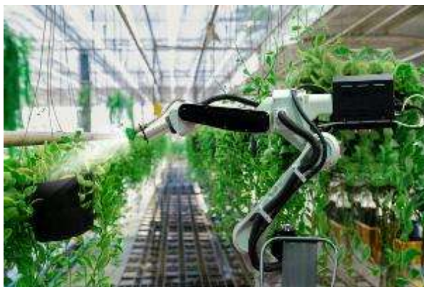
Slika 5: Prototip robota v rastlinjaku, ki z računalniškim vidom prepoznava okužene rastline in izvaja ciljno tretiranje.
