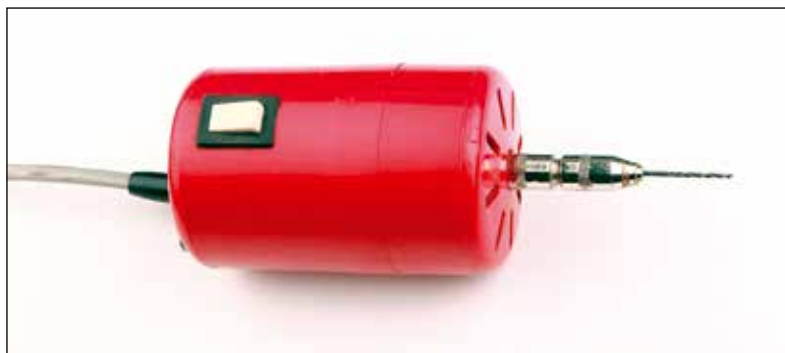
Ročni vrtni strojček MVS-1, ki je bil izdelan za vrtnje lukenj v tiskano vezje. Uporabljali pa so jih tudi čebelarji. Tiste čase je bil to prvi takšen v Jugoslaviji. Foto: Andrej Bogataj
